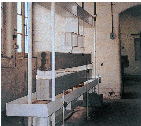
持続載荷試験状況
