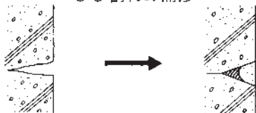
鉄筋露出の補修
