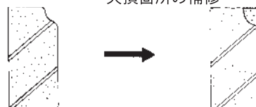
欠損箇所の補修
