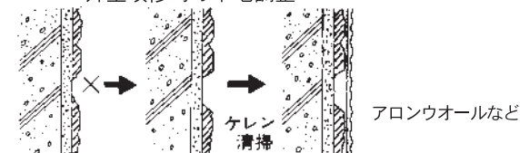
複層模様壁面、スタッコ壁、吹付けタイル下地等の欠損部の下地調整
