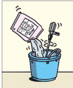
攪拌しながら アロンQDタイルセッター 20kg逐次投入
